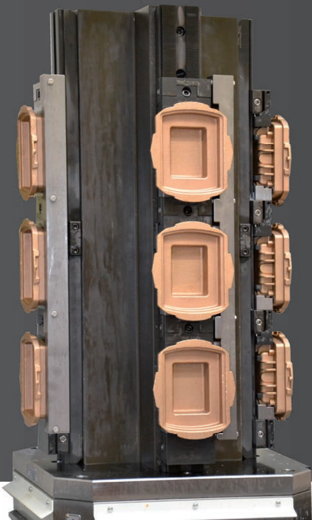
Palettenturm mit Vorrichtung und Rohteilen zur Bearbeitung
