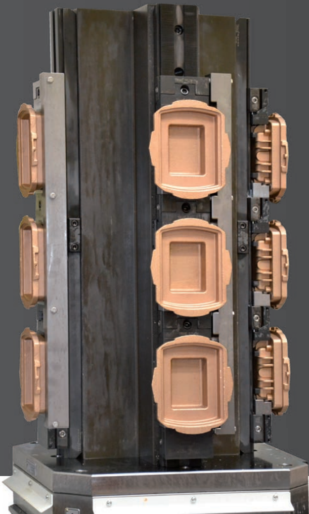
Palettenturm mit Vorrichtung und Rohteilen zur Bearbeitung
